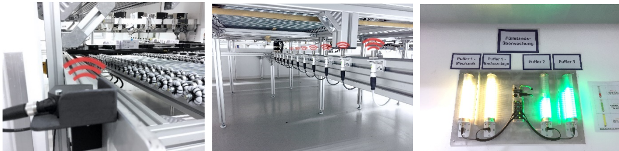
Abbildung 2: Sensorik erfasst den Stand der Montage in Echtzeit und unterstützt die Mitarbeitenden bei der Steuerung der organisatorischen Abläufe
